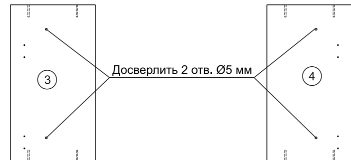
Схема 5. Досверливание отверстий
